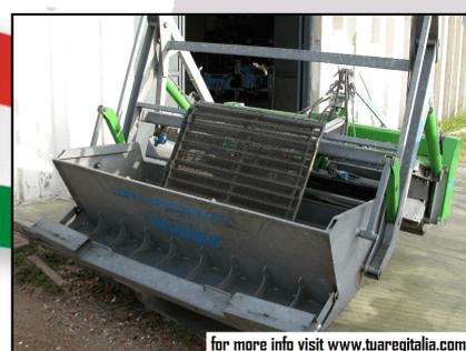
Macchina pulisci spiaggia portata da idonei trattori (80-90 HP) a quattro ruote motrici, muniti di sollevatore idraulico. Lavora per una larghezza di 190 cm. La capacità di lavoro indicata dal costruttore è di 7000-15000 mq./h ed oltre, a seconda della qualità della sabbia (bagnata, umida, asciutta) e delle condizioni dell'arenile. La profondità di lavoro, regolabile mediante sollevatore idraulico del trattore varia da 0 a 20 cm.
